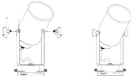
Закрепите кронштейн светильника при помощи специального винта с двух сторон.
